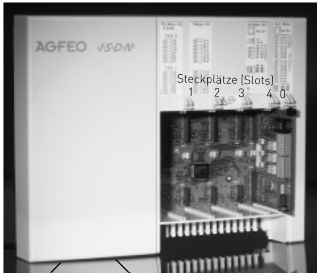
Abb. 1 TK-Anlage mit abgenommenem Deckel
