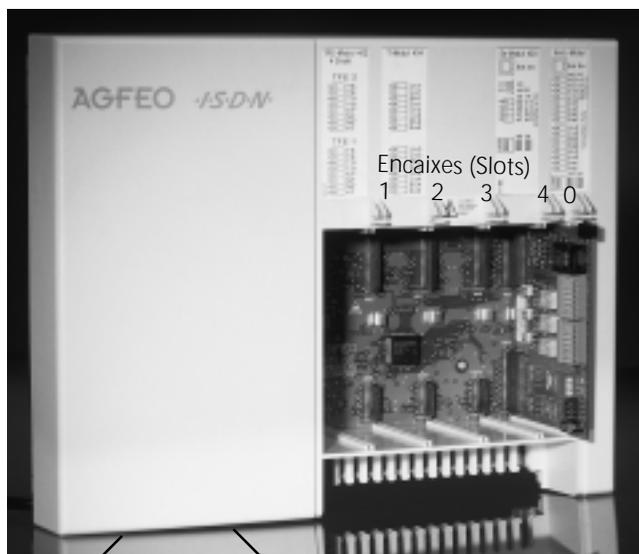
fig. 1 Sistema telefónico sem a respectiva tampa
