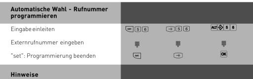
Überprüfen Sie nach dem Programmieren der Externrufnummer die automatische Wahl. Automatische Wahl einschalten, Hörer abnehmen, Wahl der Externrufnummer abwarten und richtige Verbindung kontrollieren.
